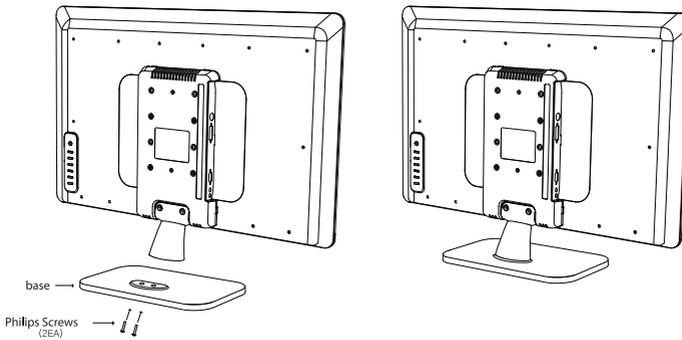
Con el fin de reducir el tamaño de la caja de cartón de embalaje, la base en el monitor viene separada. Por favor, siga las instrucciones de abajo para fijar la base al monitor:
