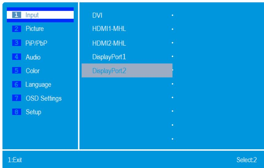
Seleccione la entrada principal. Usted puede seleccionar DVI (Dual Link DVI-D), HDMI 1-MHL, HDMI 2-MHL, DisplayPort 1, o DisplayPort 2.
