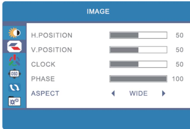
**H. POSITION:** Permite el ajuste de la posición horizontal de la imagen en la pantalla. El rango de ajuste es de 0 a 100. Esta opción sólo está disponible cuando se utiliza la entrada analógica VGA.
