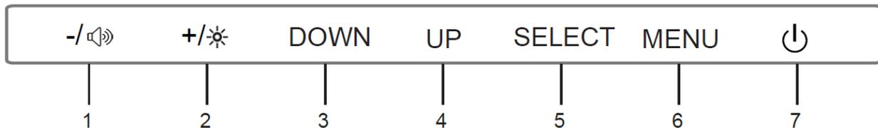
1. **-/ (volumen)**: Si se muestra el menú OSD y una entrada se ha abierto para la edición, al pulsar el -/ (volumen) botón disminuye el valor seleccionado. Si no se muestra el OSD, al pulsar el -/ (volumen) botón, se abre el control de ajuste de brillo. Ya sea con el control de brillo o de ajuste de volumen en pantalla, pulsando el -/ (volumen) botón disminuye el brillo o volumen.
