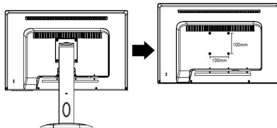
Nota: El monitor usa una medida de VESA montaje de 100x100mm.
