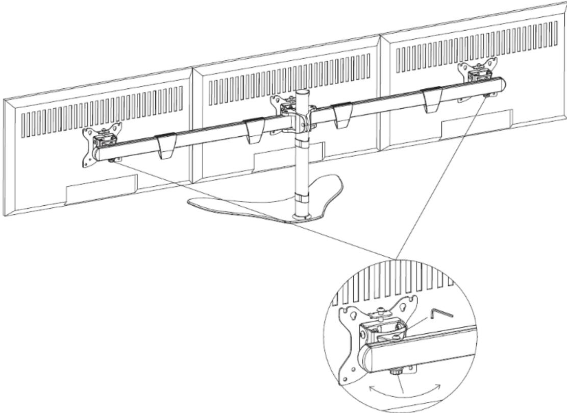
11. Se gli schermi non sono a livello, usare la **Chiave Esagonale 4mm (G)** inclusa per stringere la vite nella parte superiore della/e staffa/e inferiore/i. Per abbassare il livello della staffa, allentare la vite.
