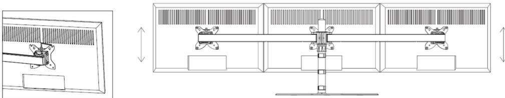
12. Per regolare l'inclinazione, innanzitutto usare la **Chiave Esagonale 5mm (H)** inclusa per allentare leggermente le due viti su ogni lato della staffa di montaggio, regolare l'inclinazione a piacere, quindi stringere le viti per fissare la staffa.
