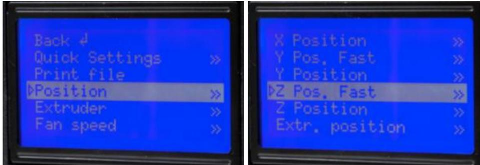
22. Seleccione **Quick Settings > Preheat PLA** (Configuración rápida > Precalentar PLA). Considere que la pantalla no cambiará inmediatamente, pero volverá a la pantalla de inicio y mostrará *Preheat PLA* en la parte inferior después de aproximadamente 30 segundos.
