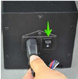
19. Espere a que la impresora se caliente y se inicialice. Cuando esté lista se mostrará *Printer ready (impresora lista)* en la parte inferior de la pantalla LCD. Seleccione **Quick Settings > Home All** (Configuración rápida > Iniciar todos). Espere a que la impresora mueva la plataforma de construcción y el extrusor a la posición inicial y luego apague la impresora.
