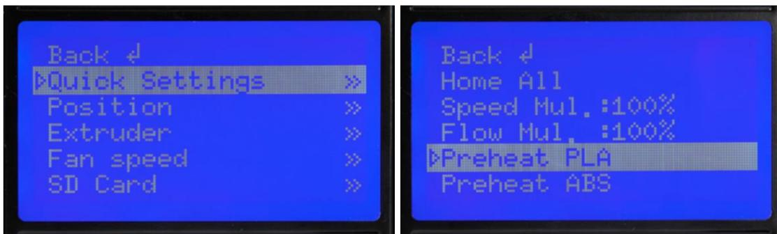
23. Controle las temperaturas del extrusor y de la placa en la pantalla LCD. Puede insertar el filamento cuando se alcancen algunos grados de la temperatura objetivo. (Considere que la pantalla aún mostrará *Preheat PLA*, incluso después de que se hayan alcanzado los valores de temperatura requeridos). Introduzca cuidadosamente la muestra de filamento dentro del orificio del extrusor como se muestra en la imagen.
