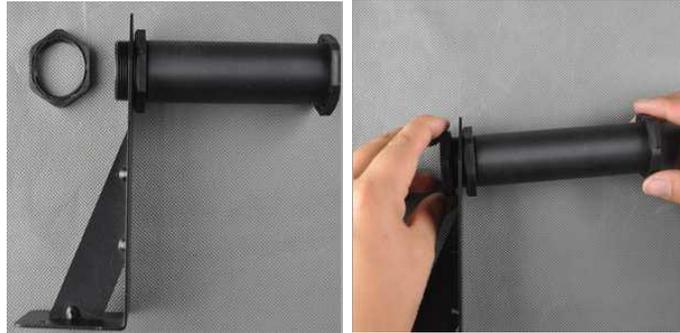
11. Puede montar el **soporte del filamento** y la **bobina** en la **estructura de la torre** o en la **fuentes de alimentación/cuadro de mando**. Use dos tornillos hexagonales y la llave inglesa hexagonal para fijarlo en la posición que quiera. Si lo monta en la estructura de la torre, asegúrese de que la bobina está montada sobre el centro de la estructura de la torre.
