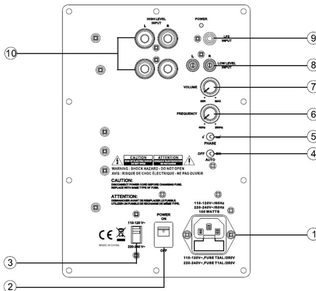
8. **ENTRADA DE BAJO NIVEL:** entradas RCA de nivel de línea estéreo para conectar a las salidas de preamplificador estéreo de un amplificador a nivel de línea normal.
