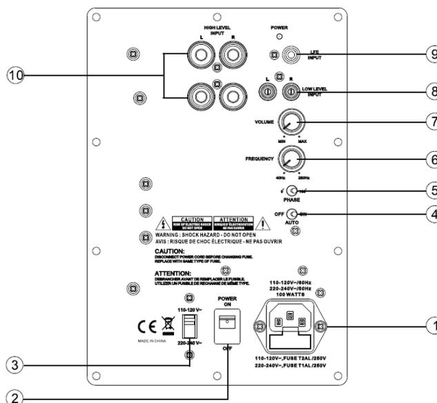
8. **INGRESSO A BASSA TENSIONE:** input RCA stereo per il collegamento delle normali uscite del preamplificatore stereo dell'amplificatore.
