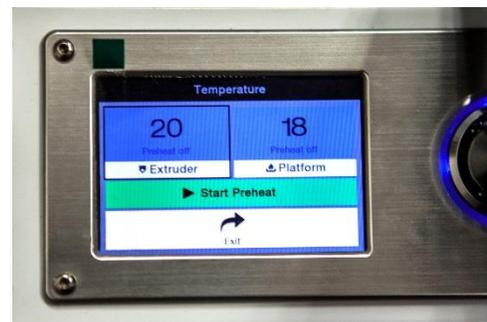
12. Stellen Sie im mit dem Verfahren die **Platform**-Temperatur auf die Zieltemperatur des Filament-Typs ein.
