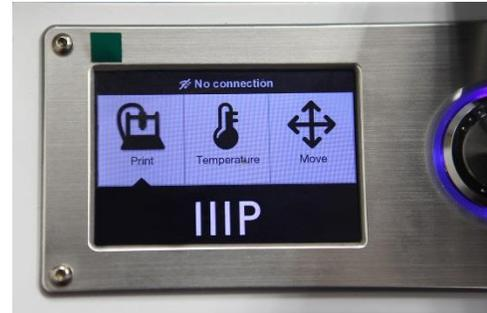
10. Drehen Sie das Kontrollrädchen im Uhrzeigersinn, um die Markierung auf den **Temperature**-Eintrag zu bewegen, drücken Sie dann die Mitte des Rädchens, um das Menü zu öffnen.
