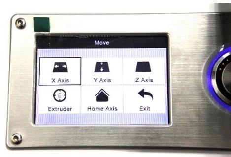
5. Drehen Sie das Kontrollrädchen im Uhrzeigersinn, um die Markierung auf den **Home Axis**-Eintrag zu bewegen, drücken Sie dann die Mitte des Rädchens, um die Funktion zu aktivieren. Der Drucker bewegt den Extruderkopf nun an die „home“-Position.
