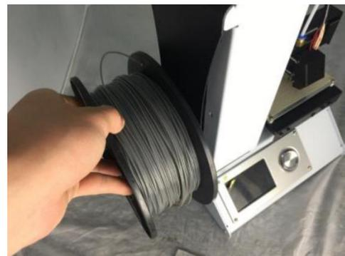
17. Führen Sie das Filament ein, während Sie den Hebel am Zufuhrmechanismus betätigen und drücken Sie es in die Öffnung. Drücken Sie so lange, bis ein Widerstand durch Berührung des Extruders spürbar ist. Lassen Sie den Hebel am Zufuhrmechanismus los.
