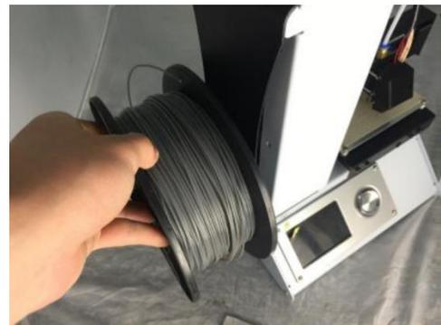
17. Mientras aprieta la palanca del mecanismo de alimentación, inserte el filamento y empújelo dentro de la abertura. Siga empujando hasta que sienta la resistencia cuando este haga tope con el extrusor. Suelte la palanca del mecanismo de alimentación.
