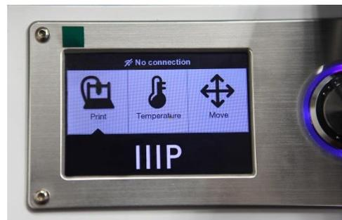
10. Ruotare la manopola in senso orario per spostare l'indicatore alla voce **Temperature**, poi premere la manopola per aprire il menu Temperature.
