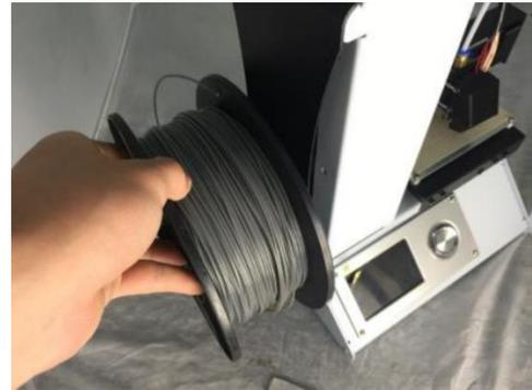
17. Premendo la leva del Meccanismo di Alimentazione, inserire il filamento e spingerlo nell'apertura. Continuare a spingere fino a sentire la resistenza provocata dal contatto con l'estrusore. Rilasciare la leva del Meccanismo di Alimentazione.
