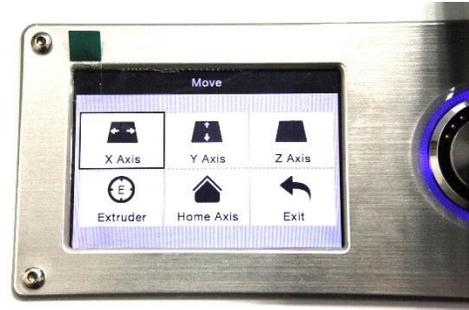
5. Ruotare la manopola in senso orario per spostare l'indicatore alla voce Home Axis [Posiz. Iniz. Assi], poi premere il centro della manopola per attivare la funzione Home Axis. La stampante sposterà la testina dell'estrusore in posizione iniziale.
