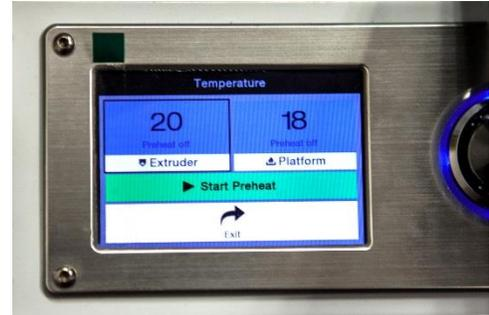
11. Utilisez la molette de contrôle pour sélectionner l'entrée **Extruder (extrudeuse)**, puis appuyez sur la molette de contrôle pour modifier la valeur. Tournez la molette de contrôle pour régler la température à atteindre, en fonction du type de filament que vous souhaitez utiliser.
