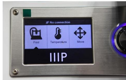
10. Tournez la molette de contrôle dans le sens des aiguilles d'une montre pour sélectionner l'entrée **Temperature (température)**, puis appuyez sur le centre de la molette de contrôle pour ouvrir le menu **Temperature (température)**.
