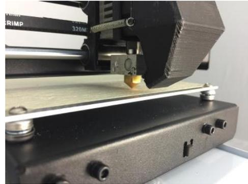
Si la hauteur est incorrecte, utilisez la clé hexagonale fournie pour procéder à un léger réglage de la hauteur de la plateforme,
