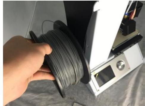
16. Placez la bobine de filament sur le dévidoir de filament qui se trouve sur le côté gauche de l'imprimante.
