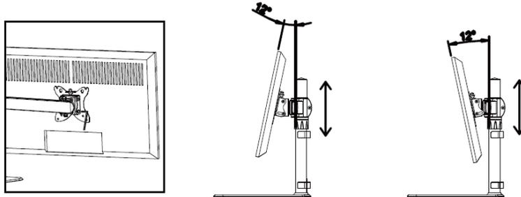
13. Per regolare l'angolazione dei monitor, utilizzare la **Brugola da 5 mm inclusa (H)** per allentare leggermente le due viti alla base dei bracci, regolare l'angolazione, quindi serrare le viti per fissare i bracci in posizione.
