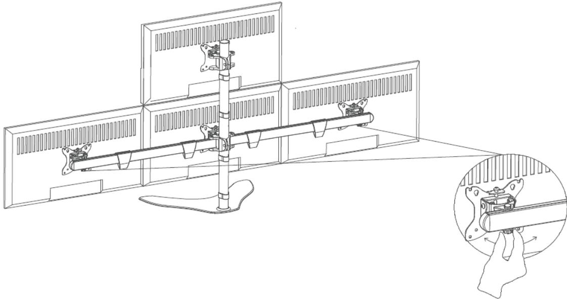
11. Se i monitor non sono allineati orizzontalmente, utilizzare la **Brugola da 5 mm inclusa (H)** per serrare la vite posta nella parte superiore della staffa inferiore, sollevando in tal modo il livello della staffa. Per abbassare il livello della staffa, allentare la vite.
