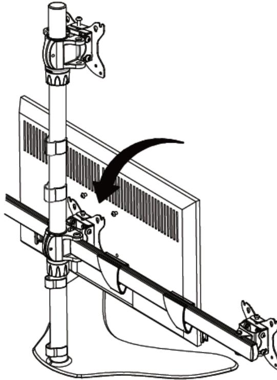
8. Inserire due (2) Viti Corte M4x12 (F) o Viti Lunghe M4x16 (G) aggiuntive nei due fori di montaggio VESA® inferiori attraversando la staffa. Stringere le viti per fissare la staffa sul retro del monitor. Se necessario, utilizzare le boccole  $\varnothing 8,0 \times \varnothing 5,5 \times 5,0$  mm (E) per ridurre lo spazio tra le teste delle viti e il retro del monitor.
