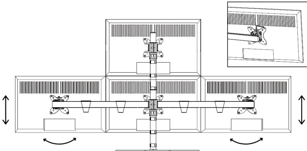
12. Per regolare l'inclinazione, utilizzare prima di tutto la **Brugola da 5 mm inclusa (H)** per allentare leggermente le due viti su ciascun lato della staffa di montaggio, regolare l'inclinazione come desiderato, quindi serrare le viti per fissare la staffa in posizione.
