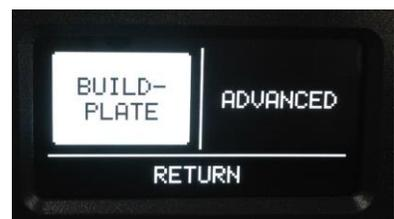
4. Für den ersten der sieben Schritte verwenden Sie den Bedienknopf, um die Bauplatte wie vorgegeben anzuheben. Drücken Sie den Bedienknopf, um die Option **WEITER** auszuwählen, wenn dies abgeschlossen ist.
