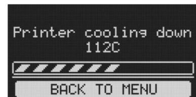
14. Sobald der Abkühlungsvorgang abgeschlossen ist, können Sie den Druck von der Bauplatte entfernen. Am besten tun Sie dies unter Verwendung des beigefügten Spachtels.
