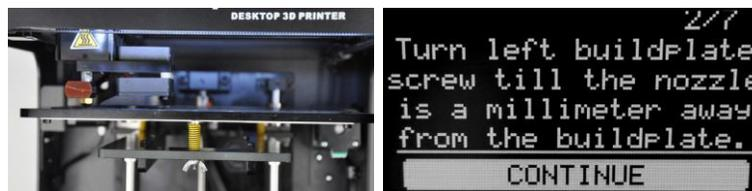
6. Für den dritten der sieben Schritte stellen Sie die Schraube unter der hinteren rechten Ecke der Bauplatte so ein, dass die Platte 1 mm von der Düse entfernt ist. Drehen Sie die Schraube im Uhrzeigersinn, um die Bauplatte zu senken, und entgegen des Uhrzeigersinns, um sie anzuheben. Wählen Sie die Option **WEITER** aus, um fortzufahren.
