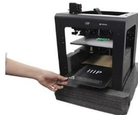
9. Entfernen Sie langsam die Zubehörbox aus der Unterseite der Druckunterlage.
