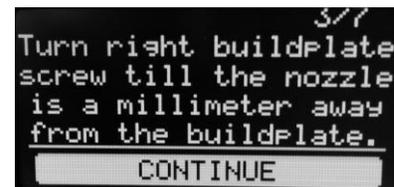
7. Legen Sie ein Blatt normales Druckerpapier zwischen die Düse und die Bauplatte und stellen Sie die Schraube unter der hinteren rechten Ecke der Bauplatte dann erneut so ein, dass eine 1 mm große Lücke besteht. Wählen Sie die Option **WEITER** aus, um fortzufahren.
