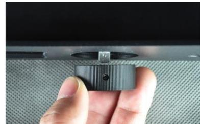
17. Drehen Sie unter Verwendung des 1,5 mm-Sechskantschlüssels die Sicherungsschraube fest, um den Bedienknopf in seiner Position zu sichern. Stellen Sie sicher, dass zwischen dem Knopf und dem Druckerrahmen genügend Platz ist, damit der Knopf frei bewegt werden kann.
