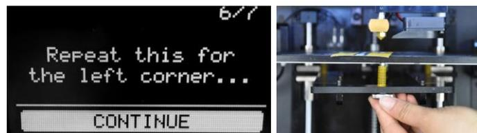
10. Der Extruder bewegt sich nach hinten rechts der Bauplatte. Stellen Sie die Schraube unter der Ecke hinten rechts so ein, dass Sie das Papier mit ein klein wenig Widerstand bewegen können. Wählen Sie die Option **FERTIG** aus, um den Prozess zu beenden.
