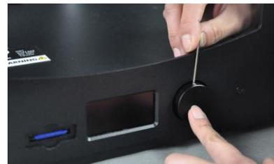
18. Drehen Sie die Z-Achsen-Schraube manuell im Uhrzeigersinn, um die Druckunterlage anzuheben.
