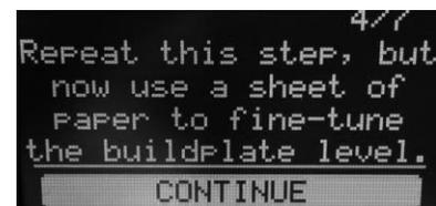
8. Der Extruder bewegt sich in die Mitte vorne der Bauplatte. Stellen Sie die Schraube unter der Mitte vorne so ein, dass Sie das Papier mit ein klein wenig Widerstand bewegen können. Wählen Sie die Option **WEITER** aus, um fortzufahren.
