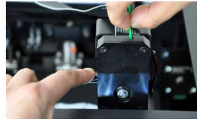
6. Drehen Sie den Bedienknopf im Uhrzeigersinn, bis Ihr Filament anfängt, aus der Düse extrudiert zu werden. Bitte beachten Sie, dass das anfängliche Material, das aus der Düse kommt, eventuell nicht die gleiche Farbe hat wie Ihr Filament. Dies liegt daran, dass bei der Werksprüfung dieses Druckers ein wenig Rest-Filament in der Düse geblieben sein kann. Drehen Sie den Bedienknopf so lange, bis das Material in der korrekten Farbe extrudiert wird. Drücken Sie den Bedienknopf, um fortzufahren.
