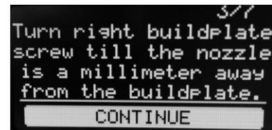
7. Introduzca una hoja de papel normal de impresora entre la boquilla y la base y reajuste el tornillo bajo la esquina inferior derecha de la base hasta dejar 1 mm de separación. Seleccione la opción **CONTINUE** para ir al siguiente paso.
