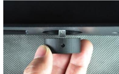
17. Apriete el tornillo de bloqueo para fijar el selector con la llave de 1,5 mm. Asegúrese de dejar un pequeño margen entre el selector y la estructura de la impresora para poder moverlo con libertad.
