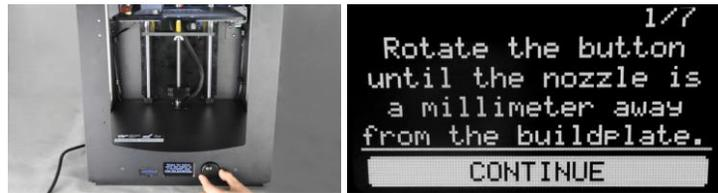
5. En el paso 2/7, ajuste el tornillo que está bajo la esquina trasera izquierda de la base hasta que la base esté a 1 mm de la boquilla. Gire el tornillo hacia la derecha para bajar la base y hacia la izquierda para elevarla. Seleccione la opción **CONTINUE** para ir al siguiente paso.
