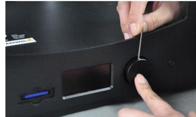
18. Gire la guía de eje Z manualmente para elevar la base de impresión
