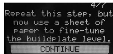
8. El extrusor se desplazará hasta la parte delantera central de la base. Ajuste el tornillo bajo la parte delantera central hasta que note una ligera resistencia al mover el papel. Seleccione la opción **CONTINUE** para ir al siguiente paso.
