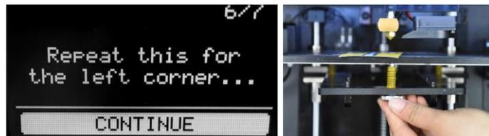
10. El extrusor se desplazará hasta la parte trasera derecha de la base. Ajuste el tornillo bajo la parte trasera derecha hasta que note una ligera resistencia al mover el papel. Seleccione la opción **DONE** al acabar el proceso.
