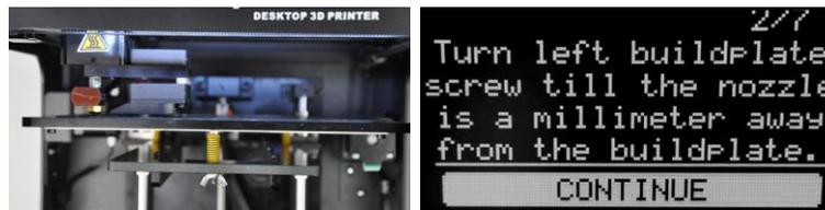
6. En el paso 3/7, ajuste el tornillo que está bajo la esquina trasera derecha de la base hasta que la base esté a 1 mm de la boquilla. Gire el tornillo hacia la derecha para bajar la base y hacia la izquierda para elevarla. Seleccione la opción **CONTINUE** para ir al siguiente paso.
