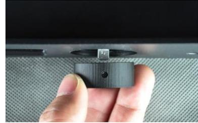
17. Serrez la vis à l'aide de la clé Allen de 1,5 mm pour fixer la molette de contrôle sur la tige. Veillez à laisser un peu d'espace entre la molette et le châssis de l'imprimante, pour qu'elle puisse tourner librement.
