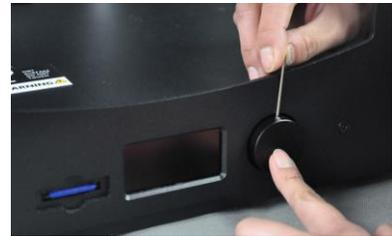
18. Tournez la tige filetée de l'axe des Z manuellement dans le sens des aiguilles d'une montre pour rehausser le plateau d'impression.
