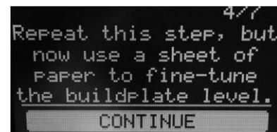
8. L'extrudeuse se déplacera alors en position avant-centre du plateau d'impression. Réglez la vis située en dessous de la position avant-centre jusqu'à pouvoir déplacer la feuille de papier tout en ressentant une légère résistance. Sélectionnez l'option **CONTINUE** pour avancer.
