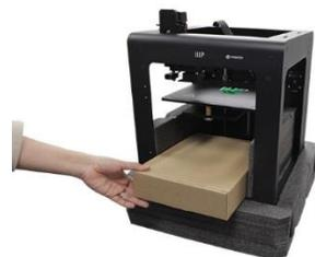
10. Repliez la mousse protectrice située sous le plateau d'impression et retirez-la précautionneusement.
