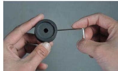
15. Tournez à la main la tige allant recevoir la molette de contrôle jusqu'à ce que la partie plate de la tige soit orientée vers le haut.
