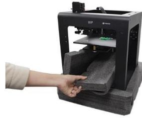
11. Coupez précautionneusement les attaches qui maintiennent en place les rails de l'axe des X et de l'axe des Y.
