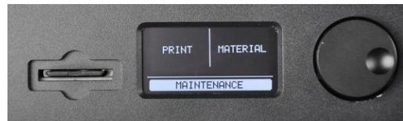
10. Tournez la molette de contrôle pour déplacer la barre de sélection sur l'option **PRINT** (impression) et validez la sélection.
