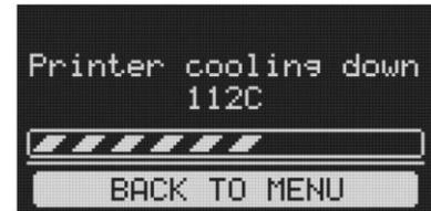
14. Une fois la phase de refroidissement terminée, vous pourrez retirer l'objet imprimé du plateau d'impression. La meilleure façon de procéder consiste à utiliser le grattoir fourni.
