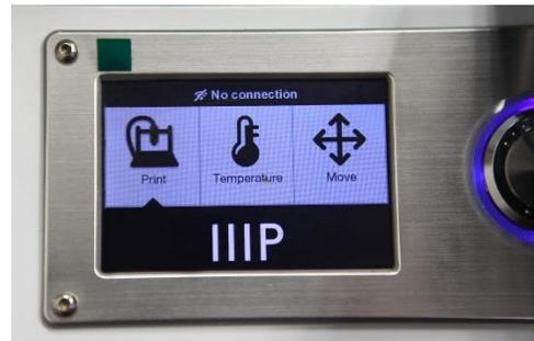
10. Gire la rueda de control a la derecha para situar el cursor en la entrada **Temperature** (Temperatura), a continuación, presione la rueda de control para abrir el menú Temperature.
