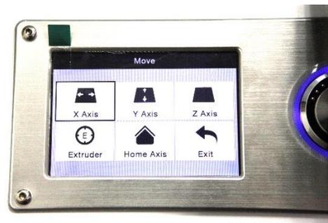
función Home Axis (Iniciar eje). La impresora moverá el cabezal del extrusor a la posición de «inicio».
