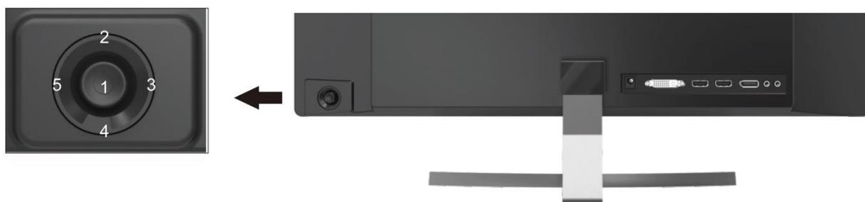
1. **Stromversorgung:** Drücken Sie den Joystick, um den Monitor einzuschalten oder in den Standby-Modus zu versetzen.
