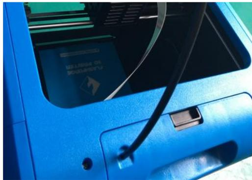
6. Abbassare manualmente il **Piano di Costruzione** in modo da lasciare circa 5cm di spazio fra l'**Ugello** dell'estrusore e il **Piano di Costruzione**.
