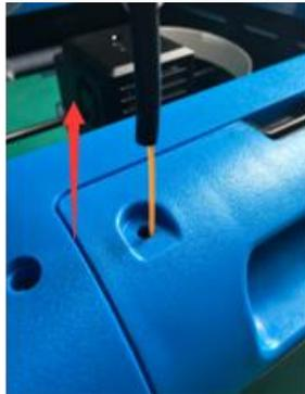
5. Inserire il tubo guida del filamento nel foro d'**Ingresso del Filamento** posizionato nella parte superiore della **Cartuccia del Filamento**.
