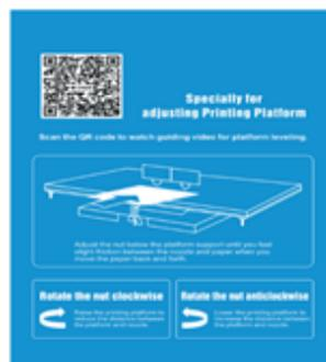
3. Una volta che l'estrusore e la piastra di costruzione smettono di muoversi, fare scorrere continuamente la **Scheda di livellamento** avanti e indietro tra gli ugelli e la piastra di costruzione e contemporaneamente regolare la manopola quanto basta in modo che la scheda provochi un leggero attrito.
