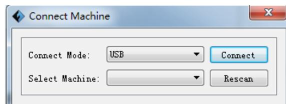
4. Impostare **Connection Mode** su **USB** e scegliere la stampante **Inventor** per l'opzione **Select Machine**. Se la stampante non compare nell'elenco **Select Machine**, fare clic sul pulsante **Rescan**. Se ancora non compare, reinstallare il software del driver.
