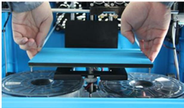
6. Rimuovere con cautela le due bobine di filamento in PLA da sotto la piastra di costruzione.
