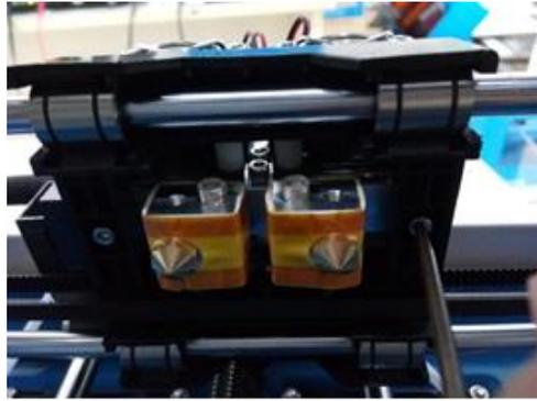
3. Utilisez la clé Allen M2.5 pour dévisser les deux boulons du turboréacteur.
