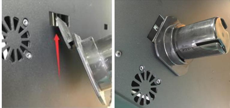
2. Setzen Sie die Filamentspule auf den Filamenthalter. Fädeln Sie das Filament durch den Detektormechanismus an der Rückseite des Druckers.
