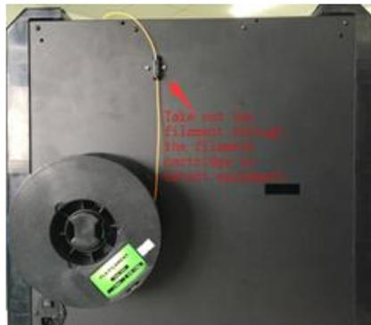
3. Führen Sie das Filament durch das Filamentführungsrohr.
