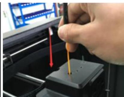
5. Drücken Sie das Filament weiter in den Extruder, bis es vorn aus der Düse herauskommt. Drücken Sie danach den Button **Fertig**.
