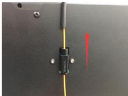
4. Setzen Sie das Filamentführungsrohr in den Detektormechanismus ein.
