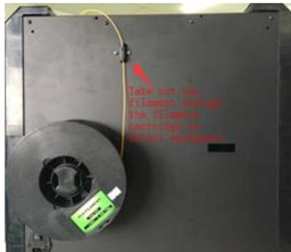
3. Introduzca el filamento a través del tubo de guía de filamento.
