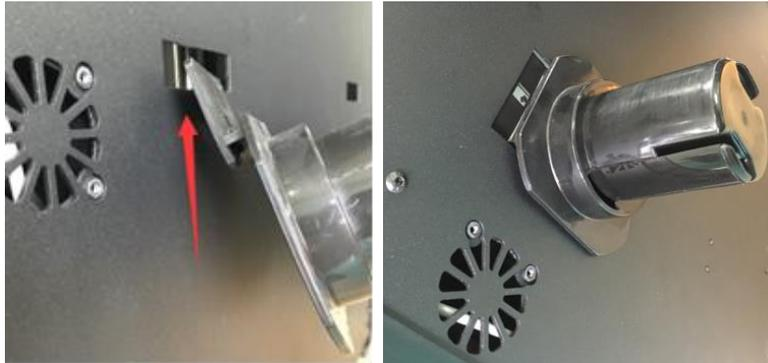
2. Coloque la bobina de filamento en el soporte de filamento. Hile el filamento a través del mecanismo de detección de filamento en la parte trasera de la impresora.
