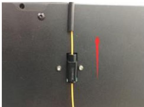
4. Inserte el tubo de guía de filamento en el mecanismo de detección de filamento.
