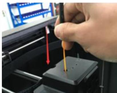
5. Continúe empujando el filamento dentro del extrusor hasta que el filamento empiece a salir por la boquilla y luego toque el botón **Done** («hecho»).
