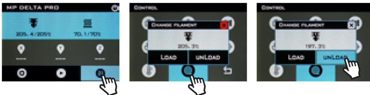
3. Tenendo fermo il sensore del filamento, ruota delicatamente la bobina durante lo scarico del filamento per evitare che si aggrovigli.
