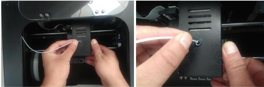
7. Öffnen Sie das Steuerungsmenü und wählen Sie die Optionen "Filament In". Warten Sie, bis das Filament vollständig geladen ist.
