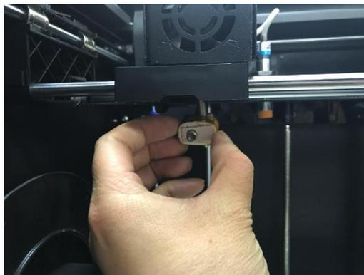
4. Lösen Sie die beiden Sechskantschrauben auf der rechten Seite vollständig, und entfernen Sie dann den Motor und den Kühllüfter.
