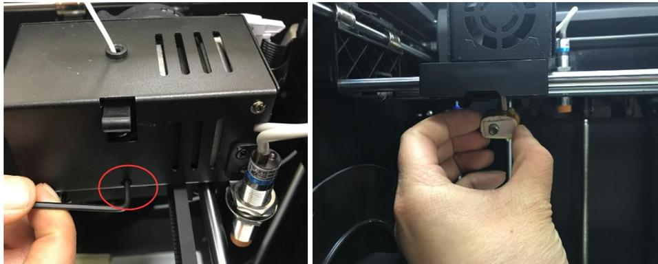
4. Desatornille por completo los dos tornillos hexagonales del lado derecho y quite el motor y el ventilador de refrigeración.
