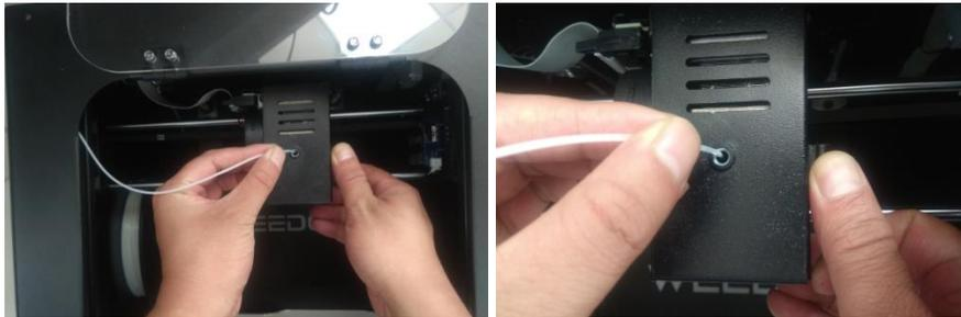
7. Abra el menú «Control» y elija «Filament In (Entrada de filamento)» en las opciones. Espere hasta que el filamento termine de cargarse.
