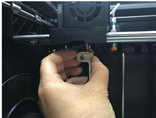
4. Svitare completamente i due bulloni a testa esagonale sul lato destro, poi rimuovere il motore e la ventola di raffreddamento.
