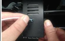
7. Öffnen Sie das Menü **Control** und wählen Sie dann die Option **Filament In**. Warten Sie, bis der Filament das Laden beendet hat.
