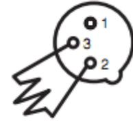
Un terminador DMX es un DMX enchufe con una resistencia de 1/4-watt 120 ohmios soldada entre los pines 2 y 3.
