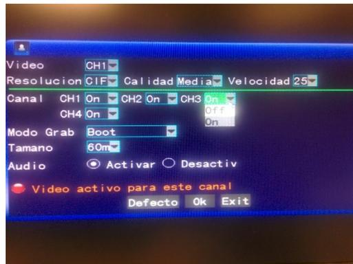
**CANAL:** Se utiliza para seleccionar si la función de grabación de vídeo está activada para el canal de grabación correspondiente.
