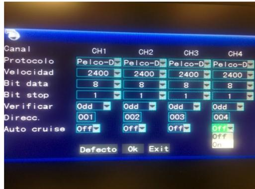
**CANAL:** Seleccione el número de canal de la cámara que desea controlar. Si se utiliza el DVR de ocho canales, haga clic en el botón "SIGUIENTE" para ver los segundos 4 canales.
