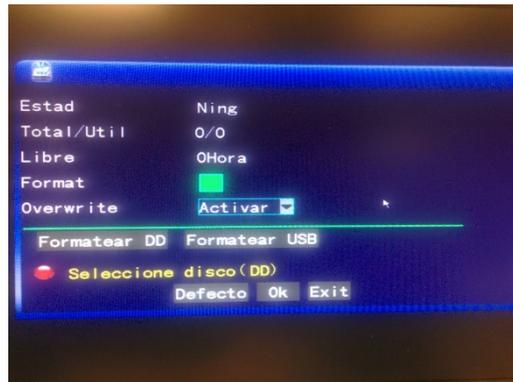
**ESTAD:** El DVR comprobará automáticamente para el buen funcionamiento de una unidad de disco duro instalado. Si el formato de las necesidades de disco duro, "SIN FORMATO" se mostrará en la pantalla el estado del disco duro y puede hacer clic en "Formatear DD" para formatear el disco duro. Si el sistema detecta un disco duro, el estado del disco duro será "en línea".
