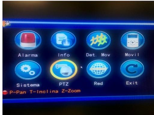
Las funciones avanzadas incluyen: Alarma, Información del sistema, Detección de movimiento (MD), Supervisión del Teléfono Móvil, mantenimiento del sistema, PTZ (Horizontal, Vertical, Focal) de instalación, y configuración de red.
